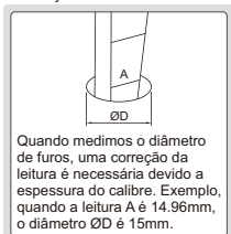
medição do diâmetro de furos
